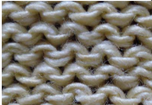
Figura 28. Dispunerea firelor simple alimentate în paralel în ochiul de tricot
