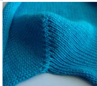
Fig. 14. Linie de conturare cu increment \Delta a = 1 ac și \Delta r = 1 rând – aspectul tricotului
